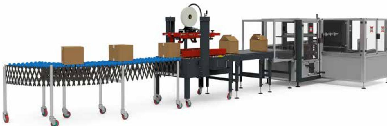
Formadora automática de cajas BEM200 salida izquierda + Transportador de rodillos libres
