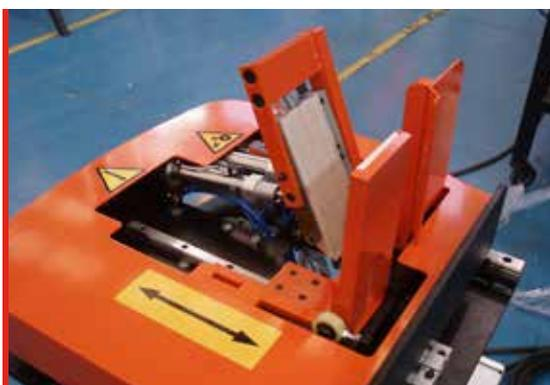
Al combinar diferentes prestaciones del diseño mecánico de los elementos con el sistema 3ALL, no existe una altura mínima de producto sobre la tarima para que la carga pueda ser envuelta hasta la parte inferior de la tarima (tablilla inferior).
