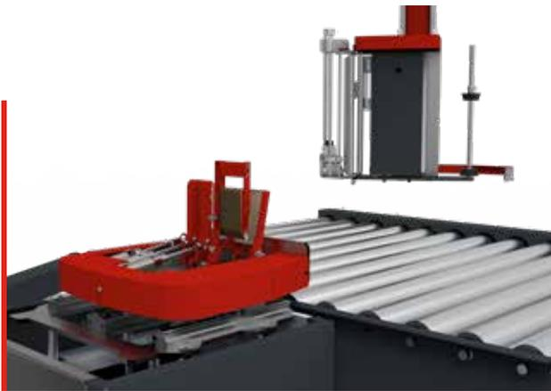
Al combinar diferentes prestaciones del diseño mecánico de los elementos con el sistema 3ALL, no existe una altura mínima de producto sobre la tarima para que la carga pueda ser envuelta hasta la parte inferior del palet (tablilla inferior).
