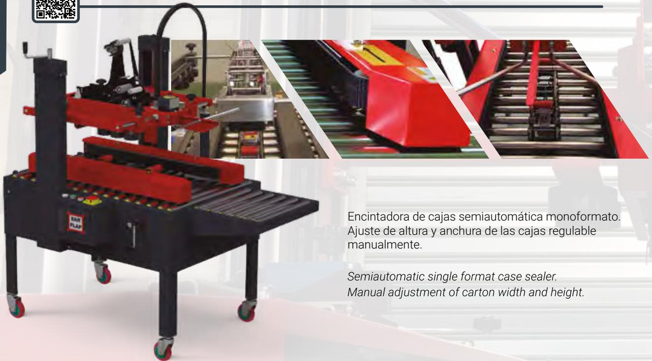
Encintadora de cajas semiautomática monoformato. Ajuste de altura y anchura de las cajas regulable manualmente.
