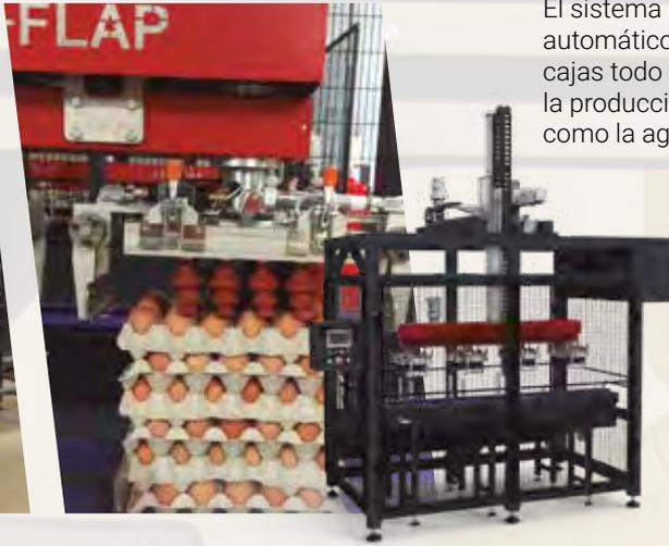
El sistema de Pick & Place combina el armado automático de cajas, el encajado y el cerrado de cajas todo en uno. Adaptamos el encajado según la producción, el tipo de producto o envase, así como la agrupación o posición dentro de la carga.
