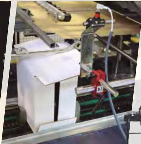
Encajadoras Wrap Around para producciones de 10 hasta 25 cajas/minuto. Según el producto o envase, puede ser de encajado lateral o superior.
